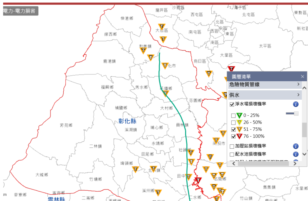
圖 1-3-17 模擬淨水廠損壞機率
